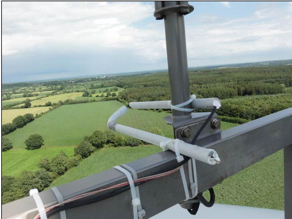
Abbildung 25: Automatisches Höhenmonitoring für Fledermäuse
